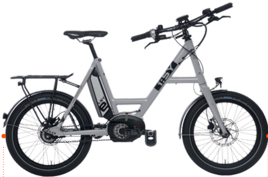
hier mit um 90° gedrehtem Lenker (einfache, werkzeugfreie Handhabung SPEED LIFTER Twist "T14" - serienmäßig)
