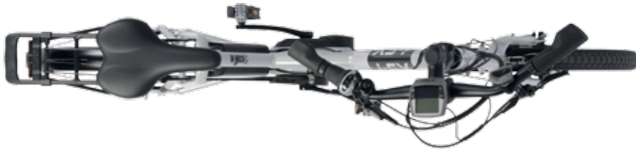
hier mit um 90° gedrehtem Lenker (SPEED LIFTER Twist "T14" serienmäßig) und mit eingeklappten Pedalen (Faltpedale serienmäßig)
